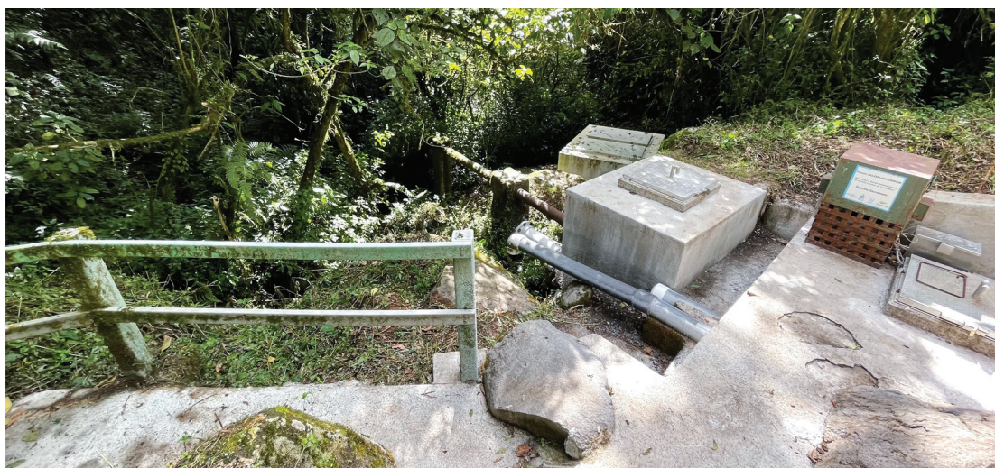
Figura 11. Toma de agua en el sector de Heredia, con auto-muestrador de agua y estación meteorológica, Agua Tica, Costa Rica
