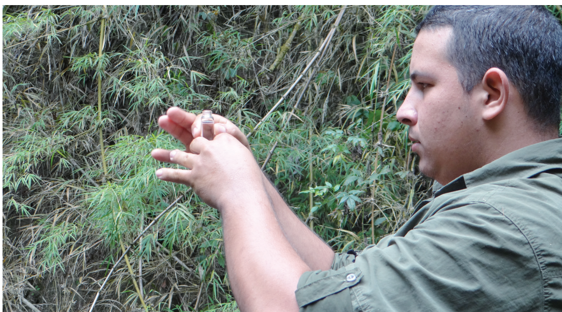
Figura 12. Toma de muestra de agua superficial para medición de isótopos estables O18 e H2 como parte del monitoreo continuo de las descargas de manantiales y arroyos y de los niveles de agua subterránea, Agua Tica, Costa Rica
